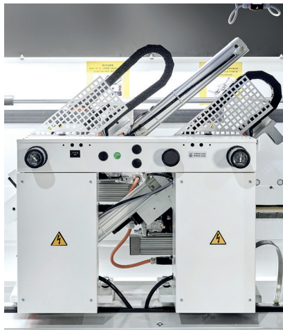
前后切装置： 直角或斜角精准切割。
